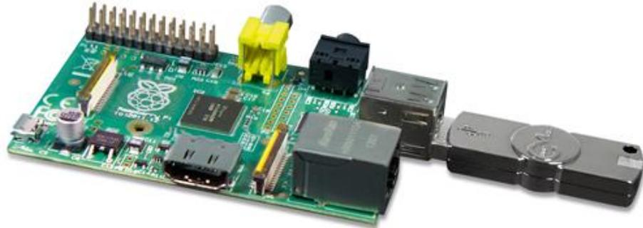
Bild: Raspberry Pi mit aufgesteckter Schutzhardware CmStick.
