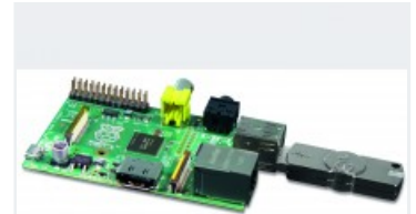
Die Codemeter-Technologie (CM) hilft, Embedded-Software zu schützen. Im Bild: ein CM-Stick an einem Raspberry Pi. (Bild: Wibu-Systems)
